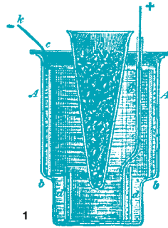
První zdroje galvanického proudu: Článek Leclancheův (1), Bunsenův (2) a Meidringův (3)
