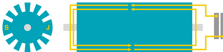
Hladký rotor turboalternátoru: rotorové budicí vinutí je uloženo v hlubokých drážkách masivních kovaných ocelových válců. Rotorové drážky jsou uzavřené nemagnetickými klíny a zabandážované kruhy z nemagnetické oceli, takže rotor má tvar hladkého válce.
