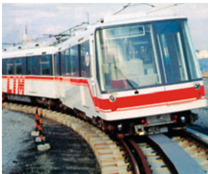
První experimentální souprava metra LIM, tažená putujícím magnetickým polem lineárního elektromotoru podél hliníkového pásu mezi kolejemi
