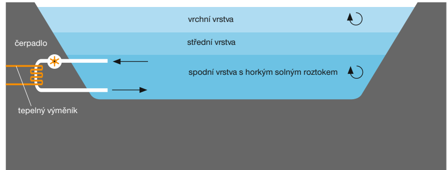
Rozložení slaných vrstev ve slunečním „rybníku“
