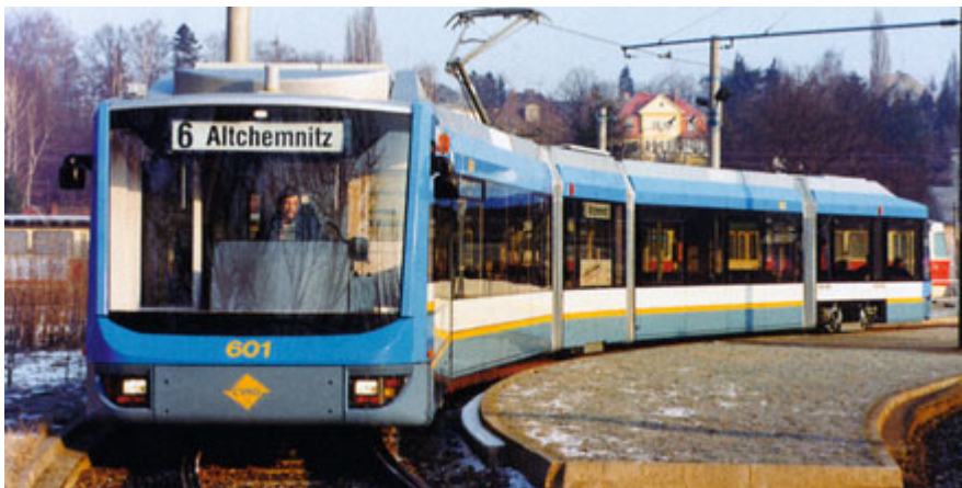
Tyristorová článková nízkopodlažní tramvaj Variobahn má nástupní plošiny jen 30 cm nad temenem kolejnic
