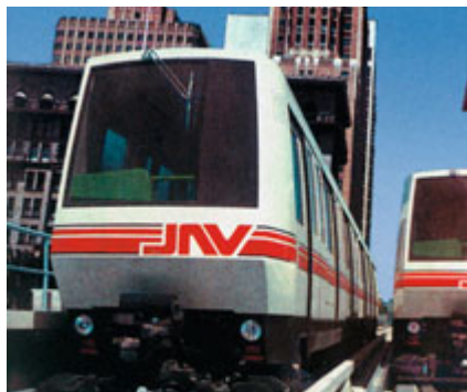
Minimetro ve francouzském Lille – bez řidiče a na pneumatikách. Pohon obstarávají dva motory o výkonu po 120 kW, napájené sběračem z postranní proudové kolejnice.
