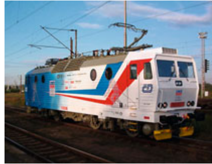
Česká dvousystémová elektrická lokomotiva 363 065-4 (3260 kW, služební hmotnost 86 t)
