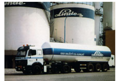
Zásobníky pro uskladňování a autocisterna pro přepravu zkapalněných plynů
