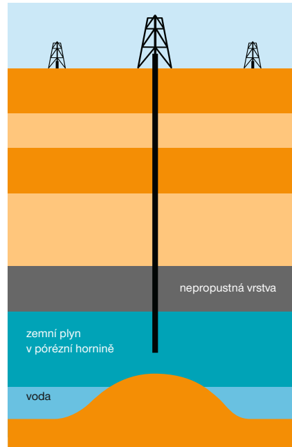
Podzemní skladování zemního plynu ve zvodnělých vrstvách
