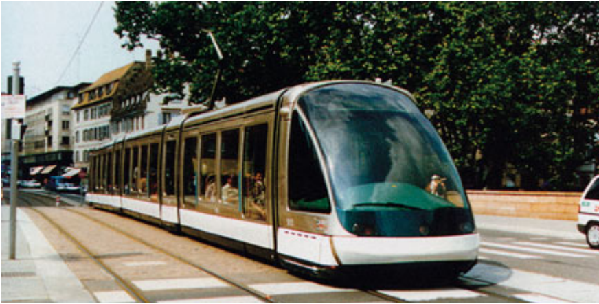
Tříčlanková nízkopodlažní „Eurotramvaj“ s nevšedním italským designem (ve Štrasburku) otevírá výkonem 300 kW a rychlostí 70 km/h novou éru tyristorových tramvajů
