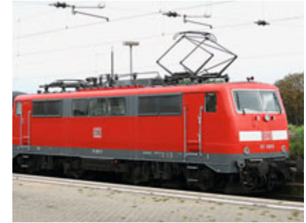
Čtyřsystémová eurolokomotiva německých drah DB s asynchronními elektromotory o výkonu 6400 kW
