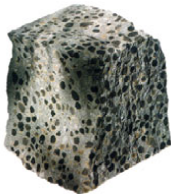
Betonový blok s použitím popílkového kameniva
