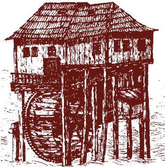
Pilotový mlýn na řece Sávě se svislým vodním kolem na spodní vodu
