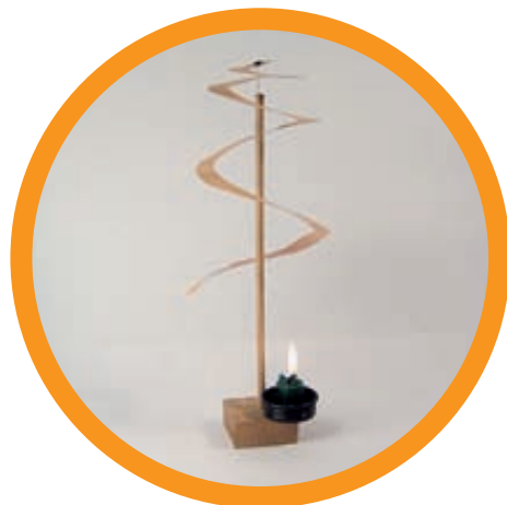
Papírový hádek točící se nad svíčkou, která je zdrojem tepla. Hádek se otáčí na hrotu špendlíku, jako ložisko slouží malá patentka.
